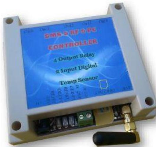
ابتدا سیم کارت و آنتن دستگاه را در محل مربوطه قرار دهید و کابل تغذیه را متصل نمایید تا دستگاه روشن شود. منتظر بمانید تا سیستم شبکه‌ی سیم کارت را شناسایی کند و LED شبکه هر ۲ تا یک بار شروع به چشمک‌زدن کند. اکنون سیستم آماده‌ی دریافت دستور می باشد. در ادامه بشرح چگونگی عملکرد و استفاده از دستگاه در دو بخش سخت افزار و نرم افزار می پردازیم.
